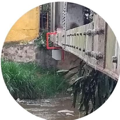
Estación Hidroclimatológica de niveles Bocas, se encuentra ubicada en el municipio de Girón. Hace parte de la Red Hidroclimatológica de la CDMB desde el año 2019. Permite el registro de las variaciones en los niveles de columna de agua para esta sección del río. La estación Bocas tiene sensor de para medir velocidad y con ello calcula el caudal.
